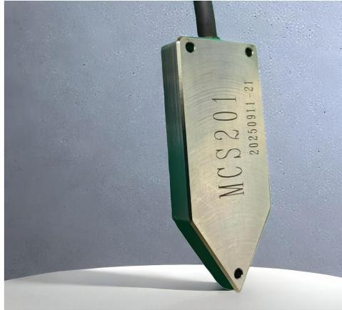
MCS201 是一款小体积、高精度数字温度传感器，57.5\*23.5\*7.6mm 的尺寸使得该传感器可以适应各种特殊场合，特别适合于在土壤、水和空气中使用，外壳采用耐腐蚀的 316L 不锈钢，并使用环氧树脂进行了全密封，使得该传感器可以在恶劣环境中长期工作。
